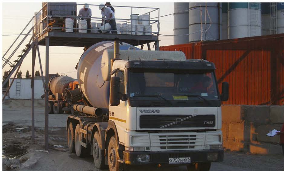
Рисунок 7.1.2 – Пример введения добавки «Пенетрон Адмикс» в автомиксер.
